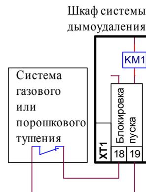
На рис. слева показан пример схемы блокировки шкафа управления вентилятором общеобменной вентиляции при включении вентилятора противодымной вентиляции.
