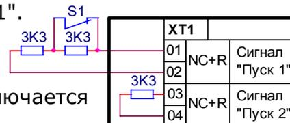
Если второй пусковой сигнал не используется, то на клеммы сигнала "ПУСК 2" (ХТ1:3 и ХТ1:4) устанавливается резистор из комплекта шкафа.
