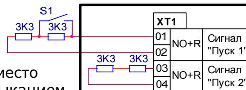
Если сигнал "ПУСК 2" не используется, то на клеммы ХТ1:(3,4) устанавливается два резистора из комплекта шкафа, а не один.
