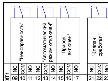
При использовании шкафа в системах противопожарной защиты на клеммы выходных сигналов шкафа при монтаже как правило устанавливаются дополнительные элементы (обычно резисторы). Тип, номиналы и схема подключения дополнительных элементов выбираются в соответствии с рекомендацией изготовителя приборов используемой системы пожарной сигнализации (пожаротушения).
